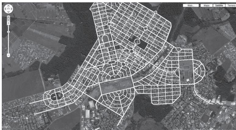
**Figura 1** - Planta atual da cidade de Cianorte, elaborada em 1955, na qual observamos um traçado regular – também chamado clássico – para o centro e um traçado irregular – orgânico – para as áreas residenciais.
